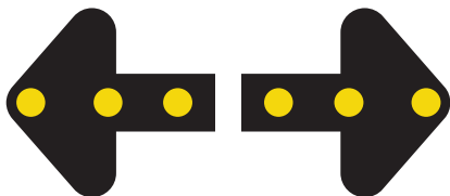
Figure 21 – Figure 4.37–10 « Demi-flèches de signalisation lumineuse – barre centrale »
