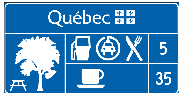
Figure 27 – Panneau « Aire de service » (I-650-1)
