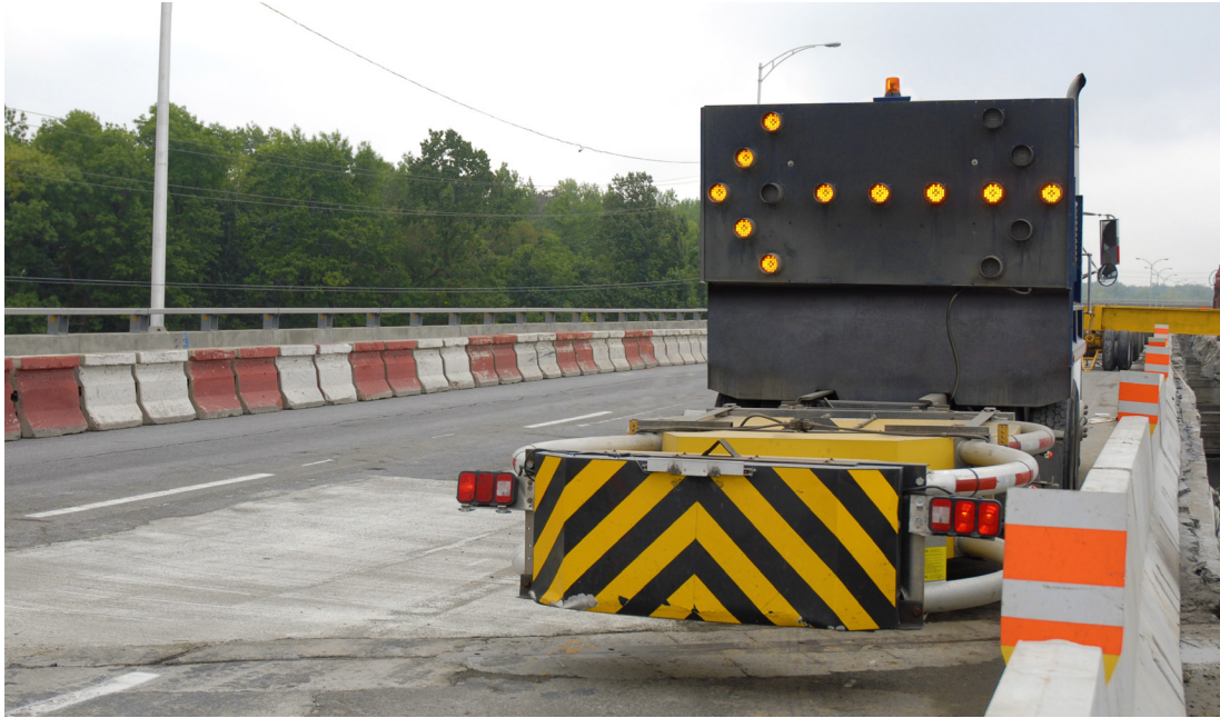
Figure 6 VP-AIFV équipé de dispositifs de signalisation
