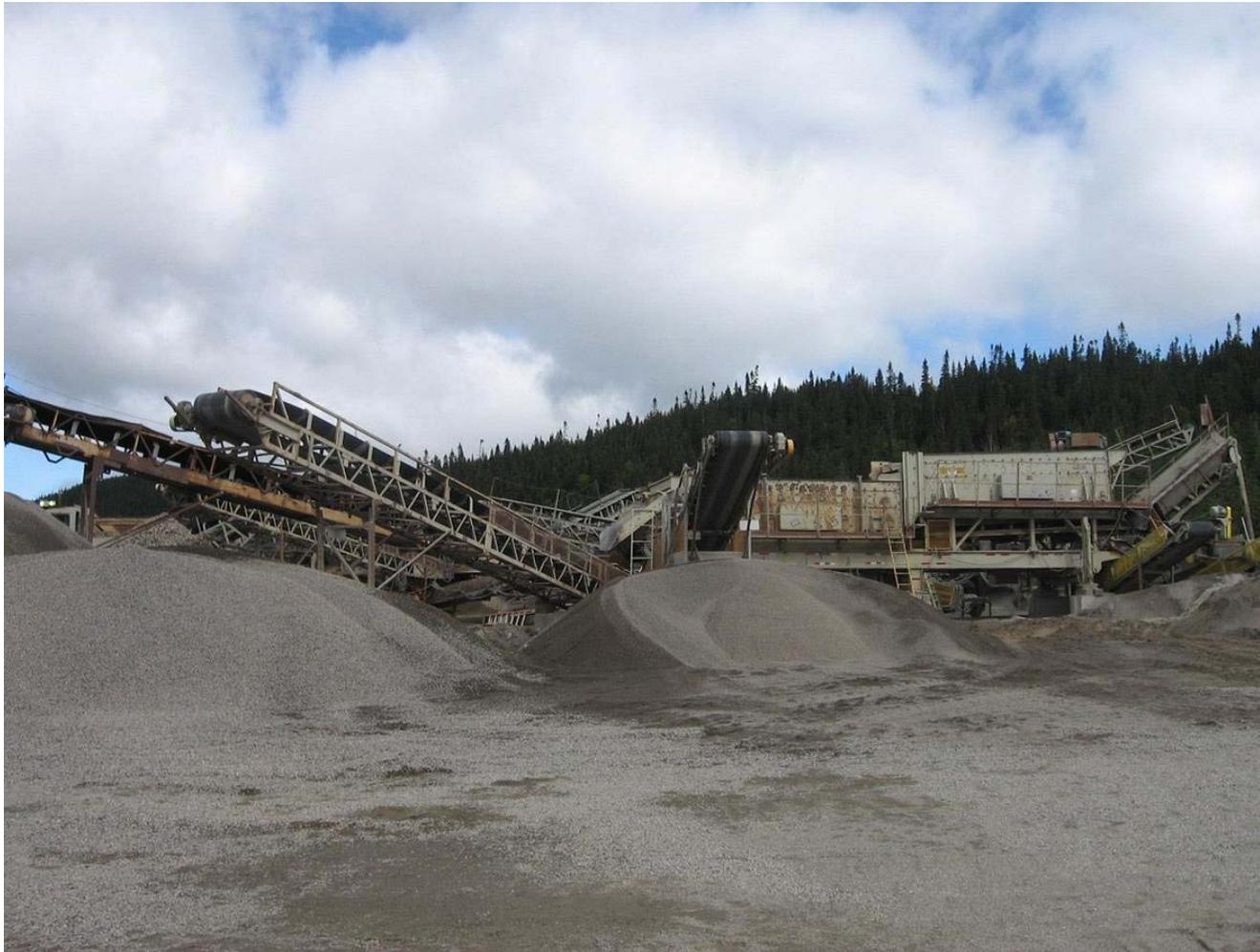
Le roc dynamité est utilisé pour produire les matériaux de fondation de la nouvelle route.
