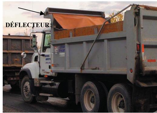
Figure 4 : Système de maintien de la bâche par un système mécanique
