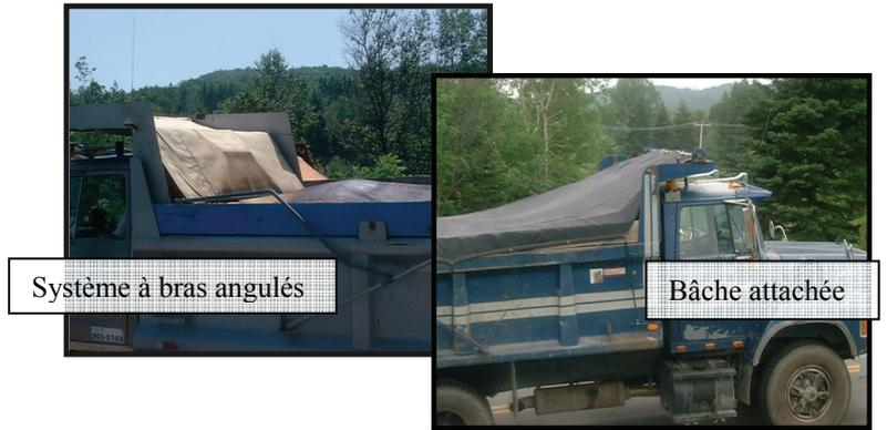
**Figure 4 : Exemples de systèmes de recouvrement efficaces**
