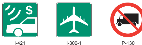
Figure 3.14–1 Exemples de pictogrammes utilisés dans la conception des panneaux de signalisation de destination
