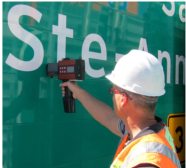
Figure 2.4-1 Appareil utilisé pour effectuer le relevé de la rétro réflexion
