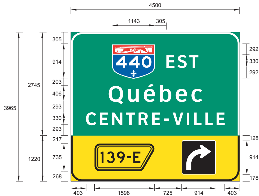
Figure 4.2-4 Exemple de panneau de direction de sortie obligatoire (I-75-2)
