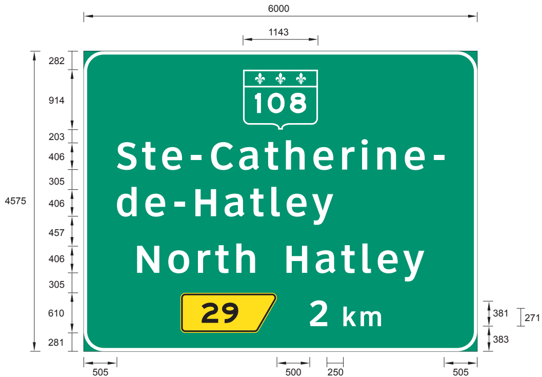
Figure 3.3-6 Exemple d'espacement entre une destination écrite sur deux lignes et une autre destination
