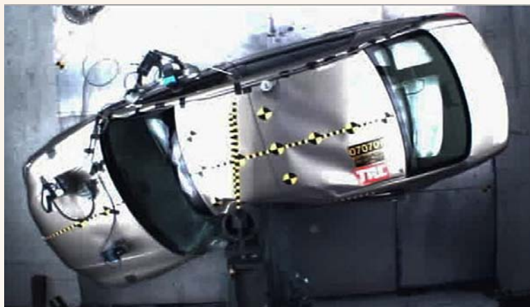
Figure 4 - Essai d'impact latéral d'un véhicule contre un fût de lampadaire (V = 32 km/h)
