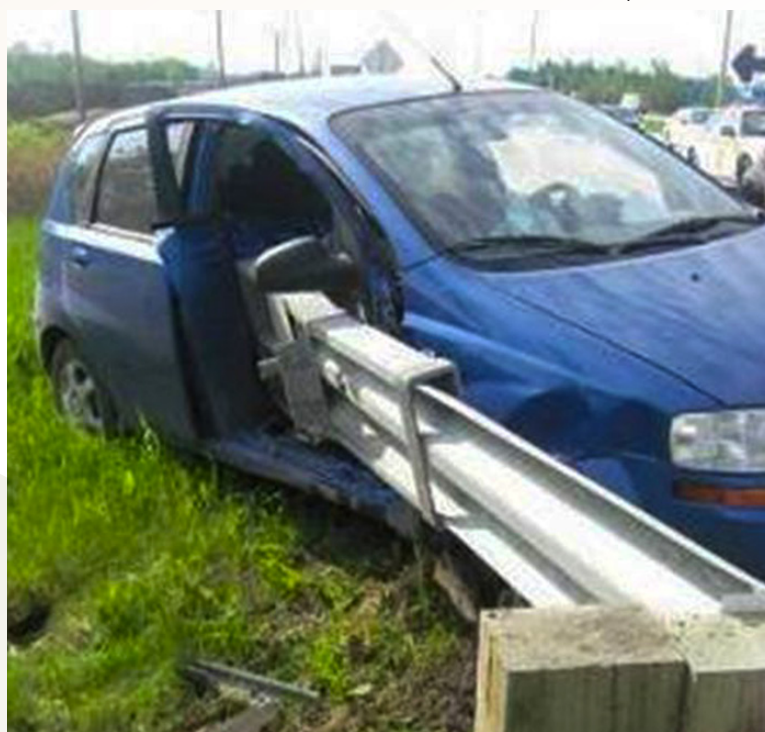
Figure 5 - Impact latéral d'un véhicule contre un dispositif de glissière semi-rigide
