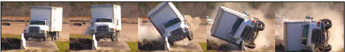
Figure 1 - Essai d'impact d'un camion contre une glissière rigide de 810 mm
