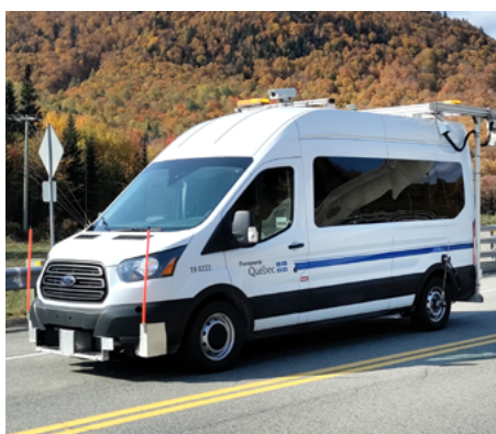
Figure 4 – Véhicule de mesure de l'état des chaussées (VMEC).
