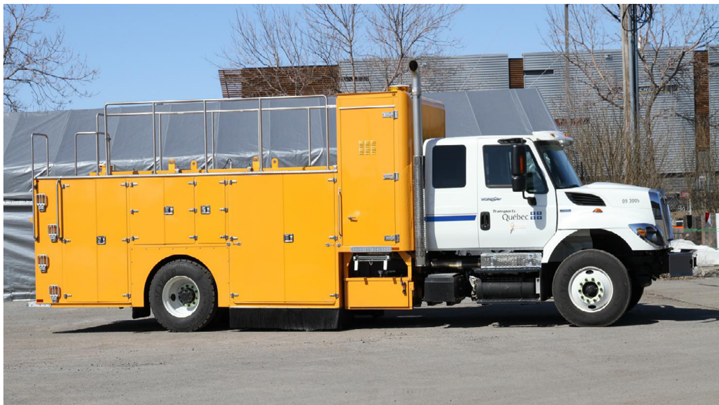
Figure 3 – Véhicule de mesure de l'adhérence des chaussées (VMAC).
