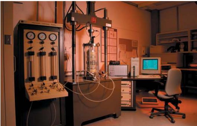
Figure 1 : Équipement triaxial à chargement déviatorique répété
