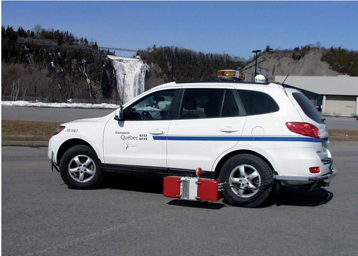
**Figure 21** Rétroreflectomètre mobile (ECODYN).
