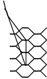
La mise en place des tirants horizontaux est réalisée avec du fil de fer (fourmi avec les gabions). Les tirants servent à relier la face visible des gabions à la face opposée. Le fil doit englober deux mailles (trois torsades).
