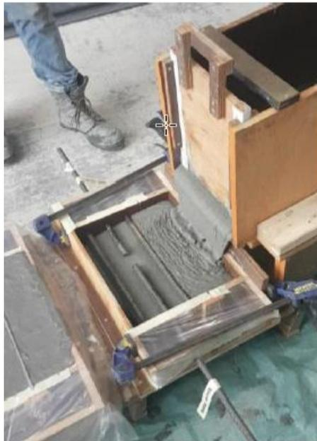
Figure 1 – Coulée du spécimen<sup>2</sup>
