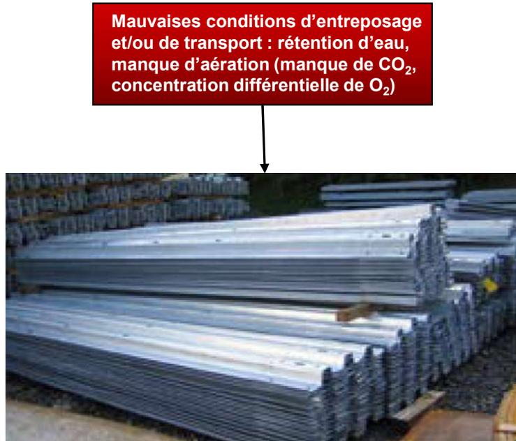
Figure 9. Pièces galvanisées mal entreposées<sup>[9]</sup>
