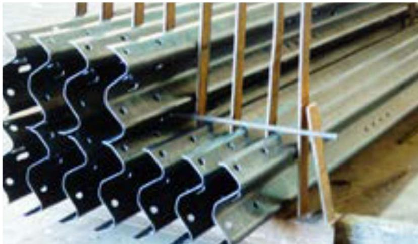
Figure 10. Exemples de bonnes conditions d'entreposage des objets galvanisés<sup>[9]</sup>
