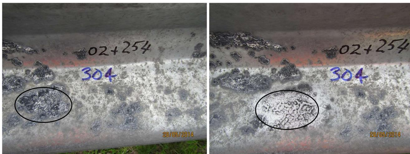
Figure 15. Nettoyage de la surface galvanisée en vue de la mesure de l'épaisseur de la galvanisation sous les dépôts de rouille blanche de niveau modéré
