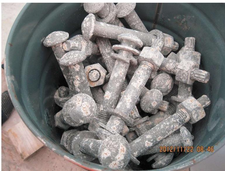
Figure 19. Boulons présentant de la rouille blanche de niveau avancé
