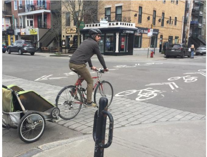
Figure 4 - Marquage destiné à indiquer la présence d'un aménagement cyclable et de cyclistes à une intersection
