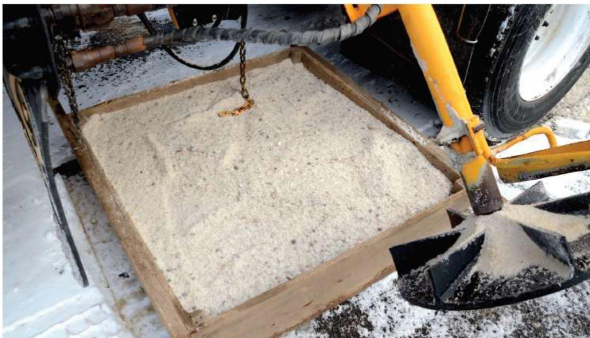
Figure 6 – Mesure de la distance entre le dessus du contenant et le niveau des matériaux
