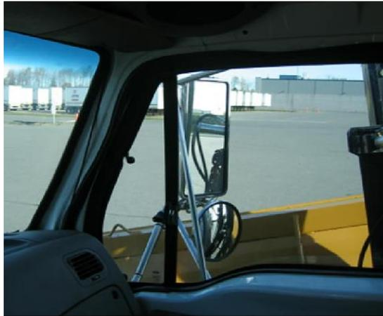
La photo au-dessus représente la vision en position transport lorsque l'aile est équipée d'un système vision tandis que la photo du bas représente la vision de l'aile lorsqu'elle est en mode déneigement.
