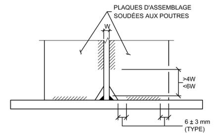
**SOUDURE TYPE AUX RAIDISSEURS D'APPUIS ET INTERMÉDIAIRES**
