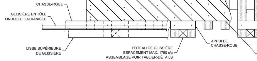
FINIR LES MADRIERS VIS-À-VIS L'INTÉRIEUR DU CHASSE-ROUE. FIXER L'EXTRÉMITÉ DES MADRIERS À 50 mm DU BORD AVEC 1 OU 2 TIRE-FONDS.
