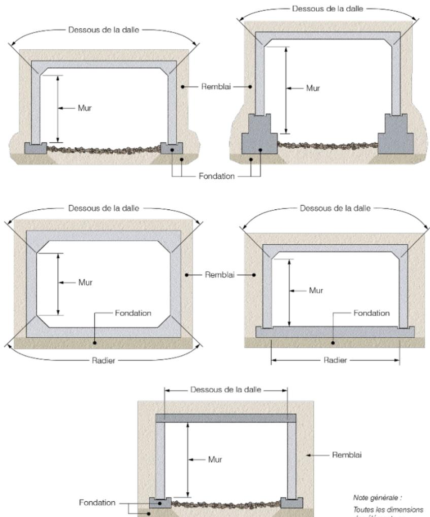
**Figure 3.2-17 Éléments de ponceaux de types 11, 12, 13 et 21**
