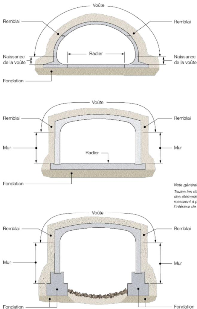
**Figure 3.2-19 Éléments de ponceaux de type 19 (suite)**
