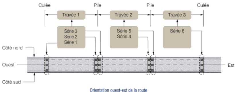
**Figure 3.2-30 Numérotation selon la présence d'éléments dans le sens longitudinal**
