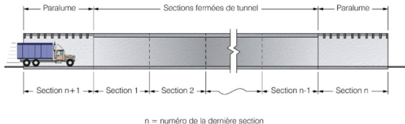
**Figure 2.5-2** Sectionnement d'un tunnel avec paralumes
