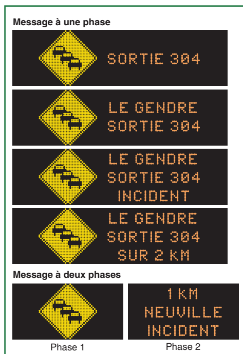
Figure 22 – Extrait de la figure 8-16-3 « Exemples de présence de congestion en aval »
