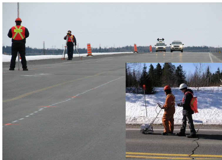
Figure 1 : Mesure des soulèvements au gel (mire et niveau et profilomètre portatif)
