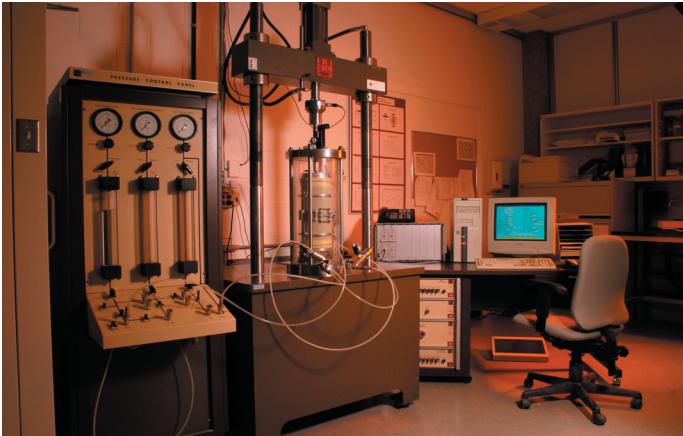
Figure 1 : Équipement triaxial à chargement déviatorique répété
