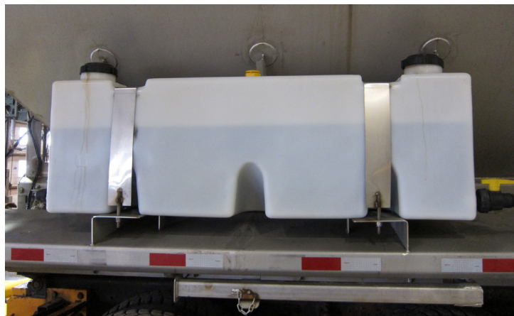
Figure 19 – Réservoir de saumure embarqué sur un véhicule de déneigement
